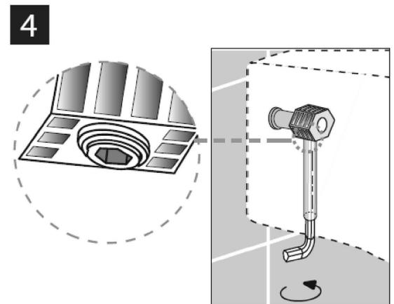
4\_Serrare il grano con la chiave fornita nel kit avendo l'accortezza di tenere il sanitario ben accostato alla parete. Si consiglia di avvitare i fissaggi un pò alla volta ,alternando l'azione su entrambi fino al completo bloccaggio del pezzo.
