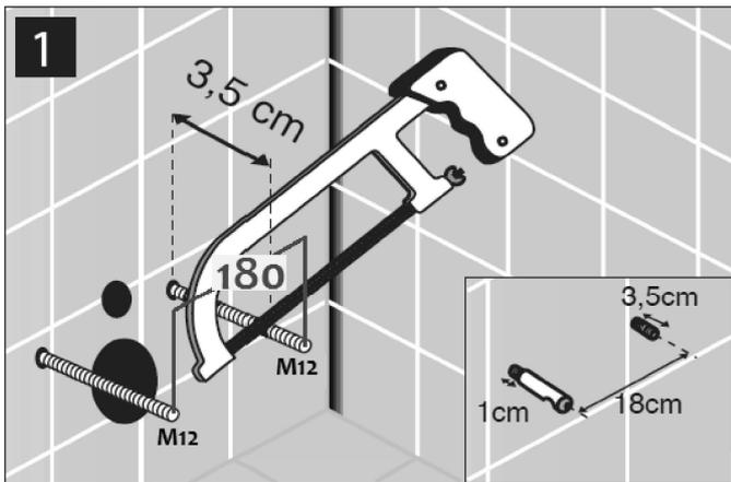
1\_Predisporre gli scarichi ed i perni delle staffe secondo le quote riportate sulle schede tecniche, quindi provvedere a tagliare i perni filettati secondo la misura riportata nell'illustrazione, avvitare i 2 cilindri in acciaio fino a lasciare 1 cm circa dalla parete.
